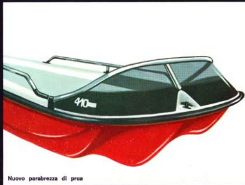
Nuovo parabrera di prua
